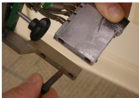
6. Poluzować dwie śruby mocujące tylny...
