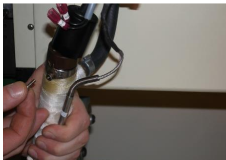
4. Wymontować śrubę mocującą
