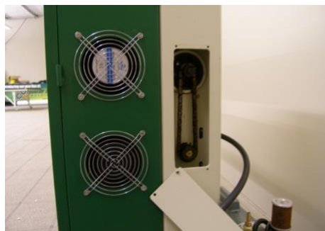
3. Zdjąć pokrywę na końcu szafki i sprawdzić łańcuchy...
