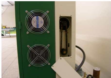
3. Remova a capa da caixa frontal...
