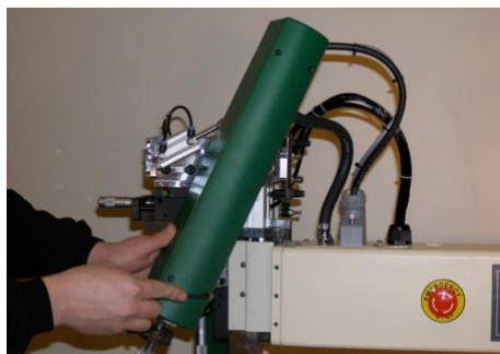
1. Desaperte a capa protetora...
