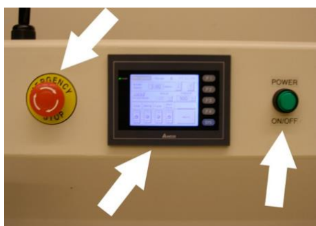
Painel de Controlo, Energia on-off, Paragem de Emergência
