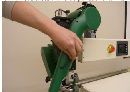
5. Remova a cobertura do puxador e cunha.
