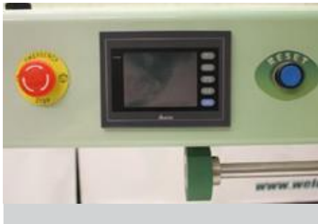
Panel de Control, Reset, Paro de Emergencia
