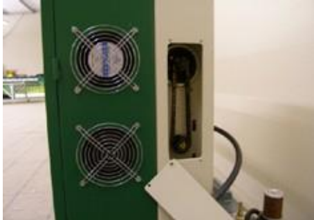
3. Remueva la cubierta final del gabinete...
