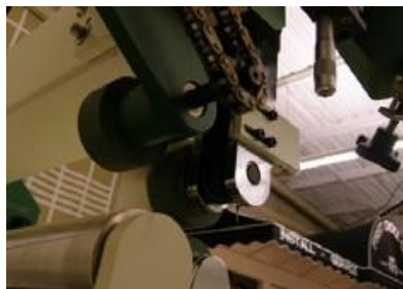
5. Retire la cubierta del jalador externo...
