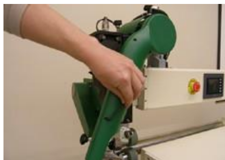
3. Afloje y remueva la cubierta.
