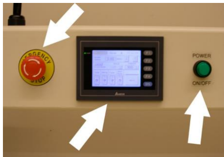
控制面板、电力开关、紧急 停止
