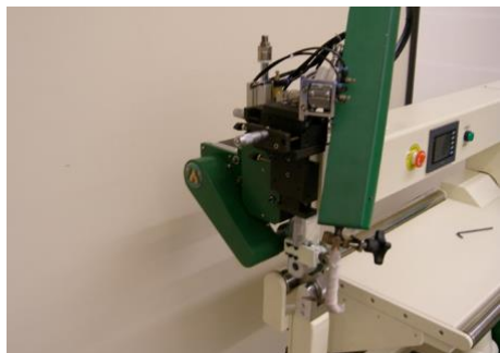
热源、上单元、加热系统调整组装
