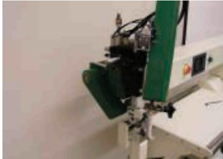
Wärmeerzeuger, obere Einheit, Heizsystem-Einstelleinheit
