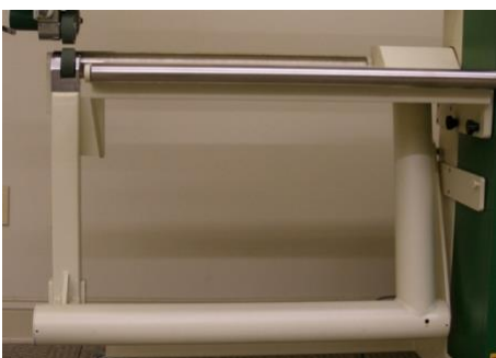
Rullo pannello superiore removibile, Braccio mobile
