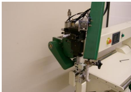
Fonte di Calore, Unità Superiore, Gruppo Regolazione Sistema di Riscaldamento
