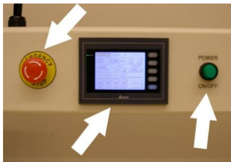
Pannello di Controllo, Alimentazione ON/OFF, Arresto d'Emergenza
