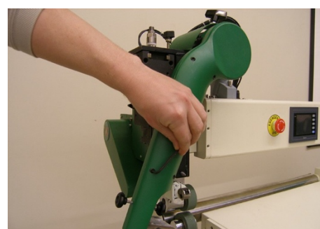
3. 枠カバーを緩め、取り外します
