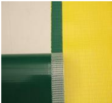
(Fig. 02) Soldadura Correcta
